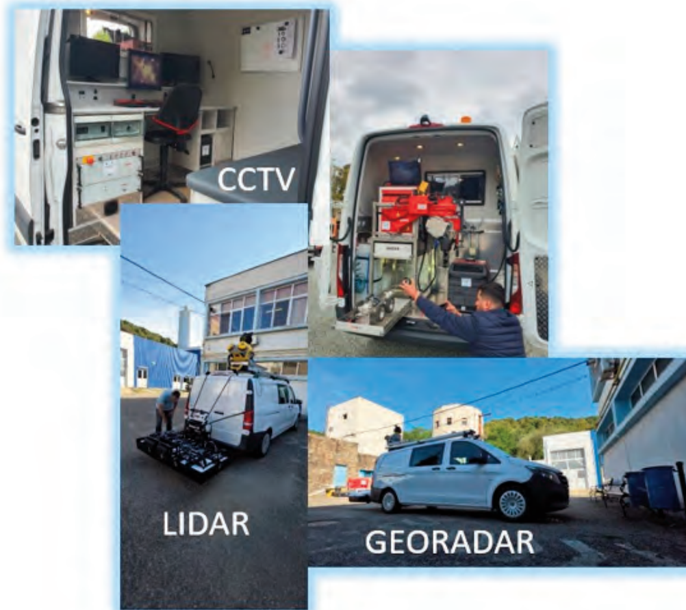
Fig. 5 - Autolaboratoare utilizate pentru achiziționarea de date spațiale de înaltă precizie / Fig. 5 - Autolabs used for acquiring high-precision spatial data
