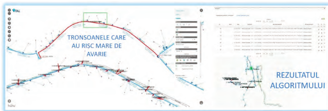
Fig. 3 - Rezultatul predicției (în tronsonul de sus rețeaua este problema iar în tronsonul de jos brânșamentele sunt problema) / Fig. 3 - Prediction result (in the upper segment the network is problematic, whereas in the lower segment the service connections are the problem)
