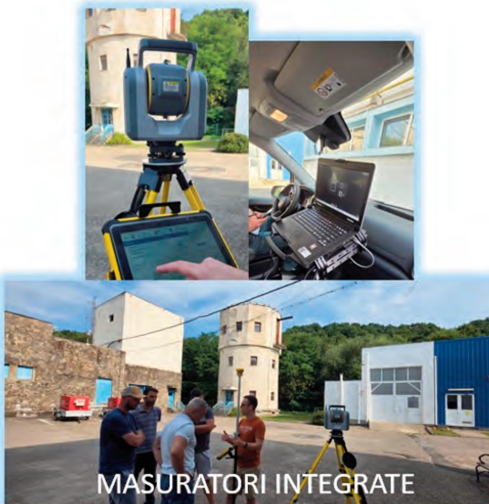
Fig. 7 - Echipamente pentru scanare terestră /
