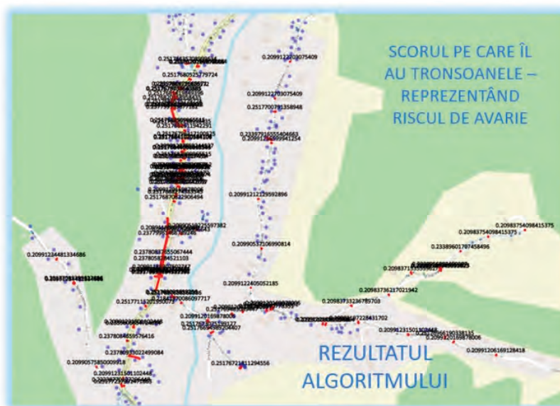
Fig. 10 - Rezultatul predicției pentru zona analizată / Fig. 10 - Prediction result for the analyzed zone
